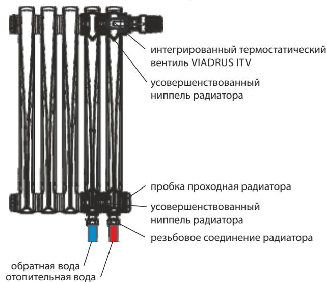
Типовая установка в соответствии с типом радиатора
