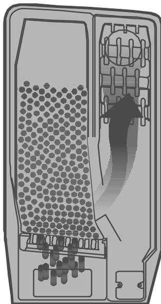
Рис. 13 Схема прохода дымовых газов через котел
