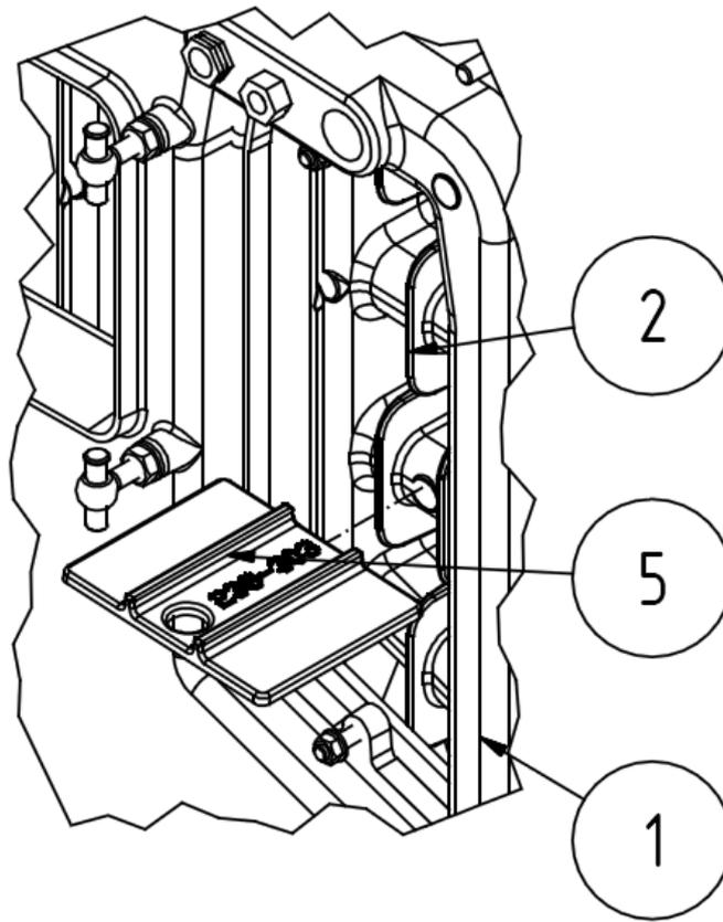
Рис. № 3а) Размещение перегородок в камере сгорания
