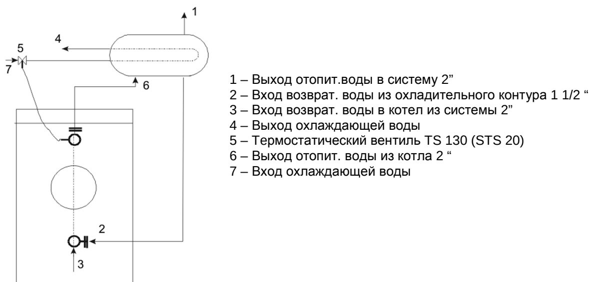
Рис. № 5 Гидравлическая схема присоединения охлаждающего контура
