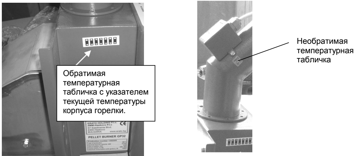
Рис. № 8 Размещение температурных табличек на горелке
